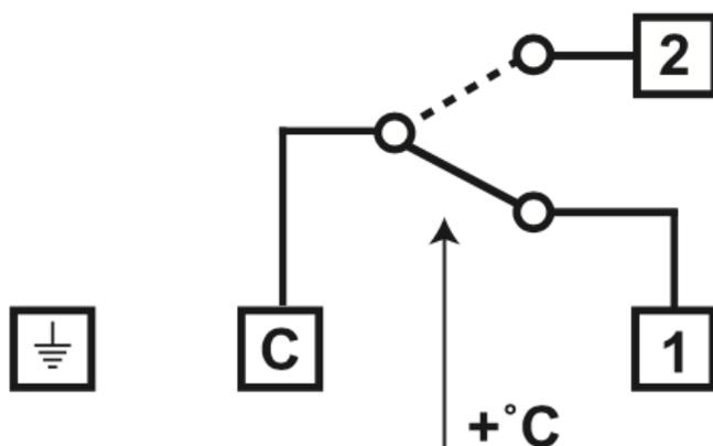
**ВНИМАНИЕ!** Для подключения термостата привлечите специалиста! Для соединения можно использовать только термостойкие изолированные проводники (например, с изолятором из силиконовой резины). Термостат не имеет двойной изоляции и должен быть заземлен.
